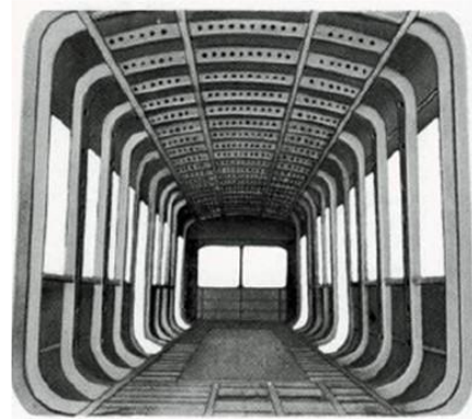
(b)航空機のような張殻構造車体
