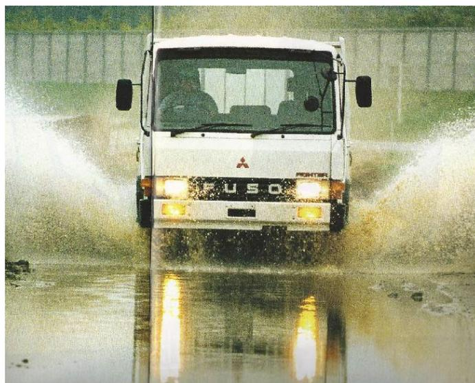
図1 濡れた路面を走行するトラックと跳ね上げる水しぶき(トラックスプレイ)
