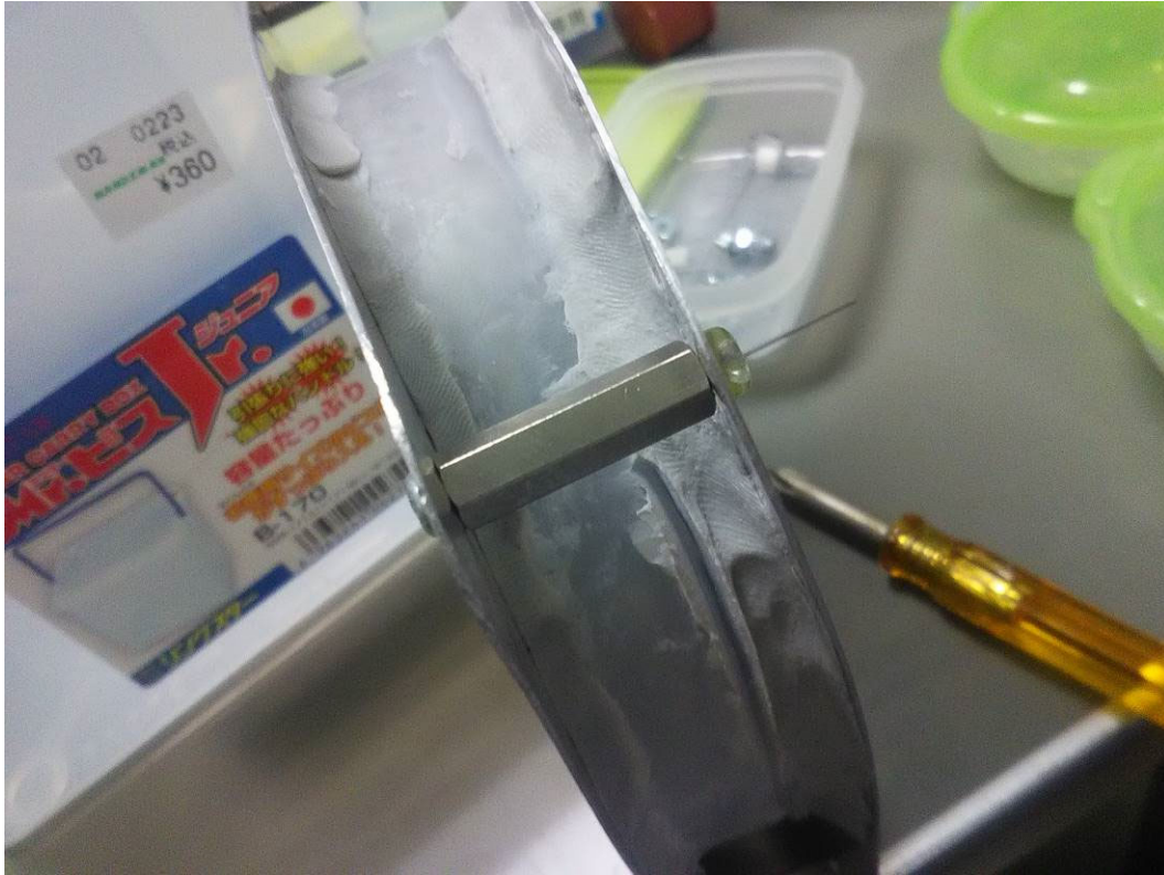
図5 大学生が分解組立をして、内側が汚損して中が見えなくなったシリンダと、「ネジの直径3mm分の隙間」を設けずに締めこまれたネジ
