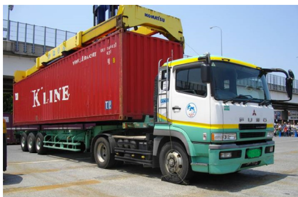
(c) 海上コンテナ運搬用トレーラー
