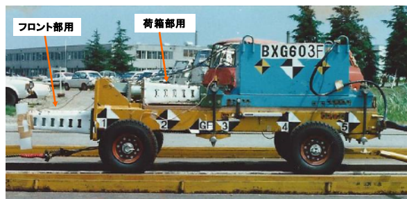
(d) 衝突試験用台車 (ピッチモーメントの影響を見るために使用した)
