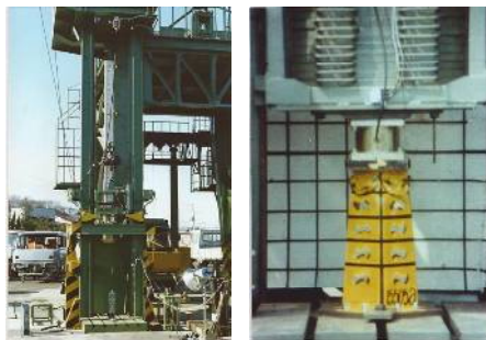
(b) 動負荷(落錘)試験 (3m/s~10m/sでの動的な負荷を加えた)
