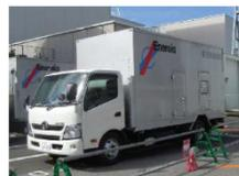
⇒非常用ディーゼル発電機他による電源供給に失敗したとしても、蓄電池(直流電源)が枯渇するまでに高圧発電機車により交流電源を確保することで、高圧注水、減圧、低圧注水によって、燃料の重大な損傷に至る事象を回避することが可能となる。
