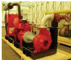
⇒原子炉補機海水ポンプ(最終ヒートシンク)が機能が喪失したとしても, 水源が枯渇するまでに**原子炉補機海水ポンプ代替品**により除熱することにより, 燃料の重大な損傷に至る事象を回避することが可能となる。
