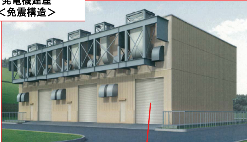
ガスタービン発電機 4,000kVA × 6台
