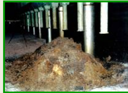
圧力抑制プール1階の溶岩状燃料含有物質の堆積物 (多孔質セラミック)
