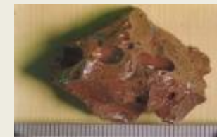
圧力抑制プール2階の溶岩状燃料含有物質の堆積物 (褐色セラミック)
