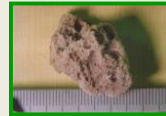
圧力抑制プール1階の溶岩状燃料含有物質の堆積物 (多孔質セラミック)
