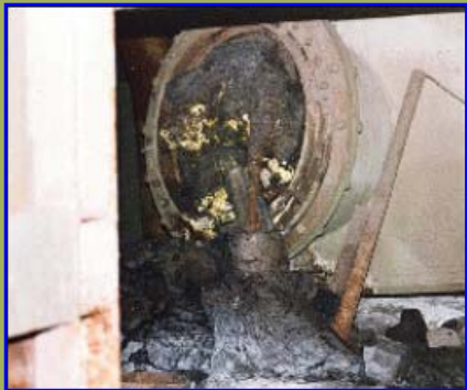
気水分離器210/6地点に堆積した 溶岩状燃料含有物質 (黒色セラミック)
