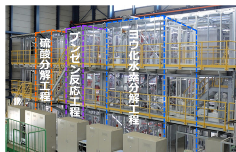
図 5 連続水素製造試験装置
