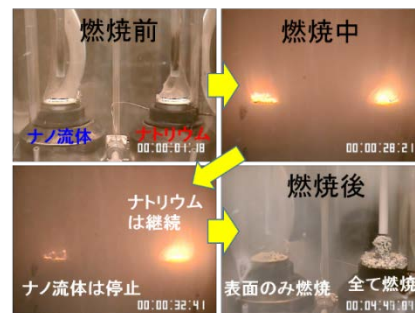
図3 ナノ流体による燃焼の自己終息現象(例)
