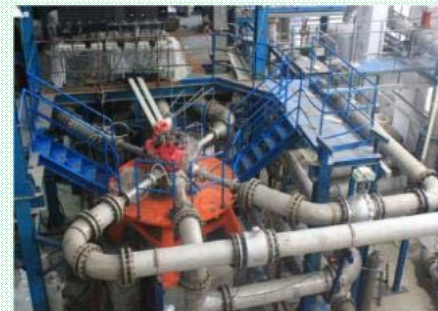
水力模拟试验台架 Hydraulic simulation testloop
