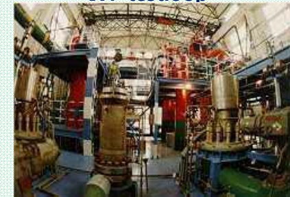
SG汽水分离热态试验台架 MW Separation testloop
