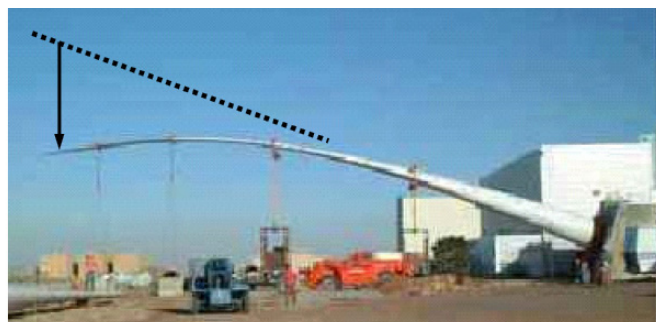
図4 2400kW風車用翼の最大荷重試験による検証状況
