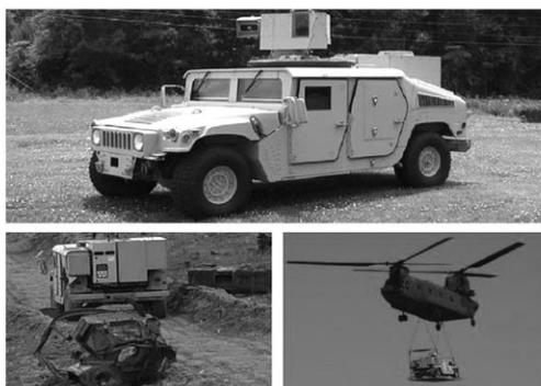
図4 ファイバレーザによる地雷除去 (IPG 社資料)
