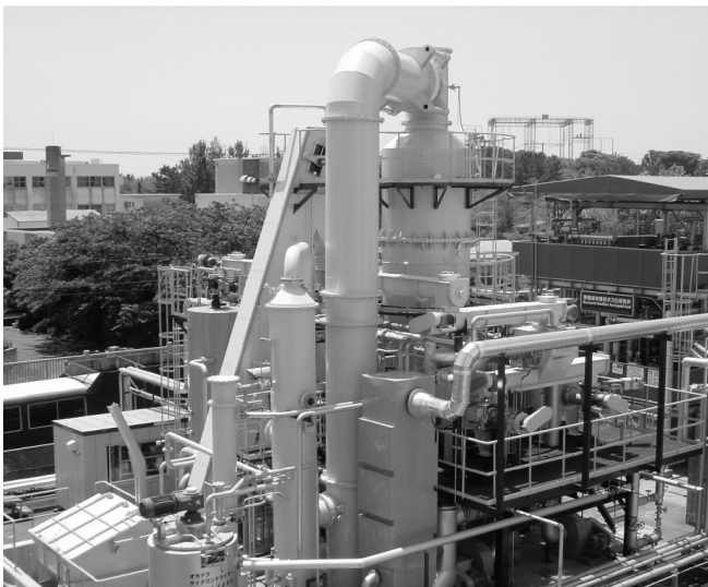
写真1 バイオマス/廃棄物発電用炭化・溶融ガス化実験設備
