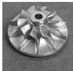
図2 外径8mmのタービン
