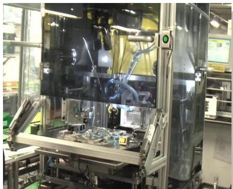
シールド板金圧入
