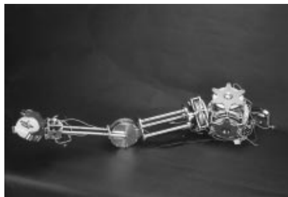
図2 球面超音波モータ(手首部)とサンドイッチ型の超音波モータを用いた人工義手スマートアーム
