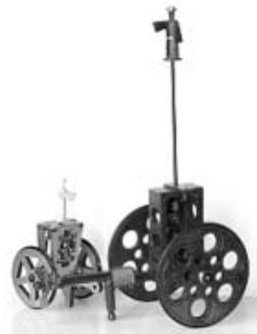
図3 円錐歯車を使用した指南車
