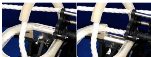
図3 ケーブルルータ部 (左：上昇時，右：下降時)
