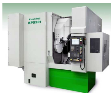
図2 KPS201型ギヤスカイビング加工機
