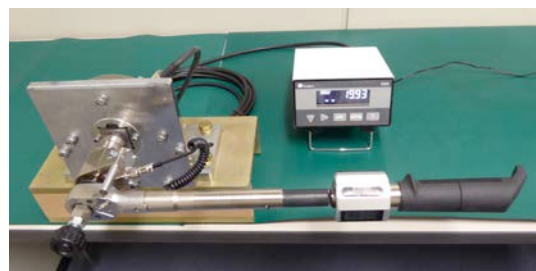
図2 締付け力検出試験状態
