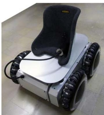
図1 真横にも，どの方向にも移動できる乗り物パーモビー
