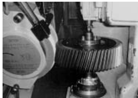
図4 研削中のコンケープコニカルギヤ
