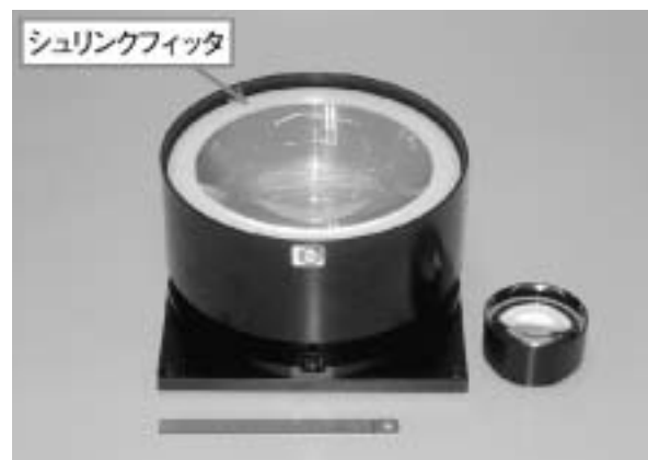
図2 加工用レンズの外観(レンズ直径180mm)
