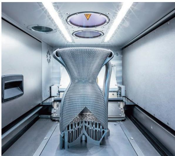
図1 ロケットのスラストチャンバーの造形例
