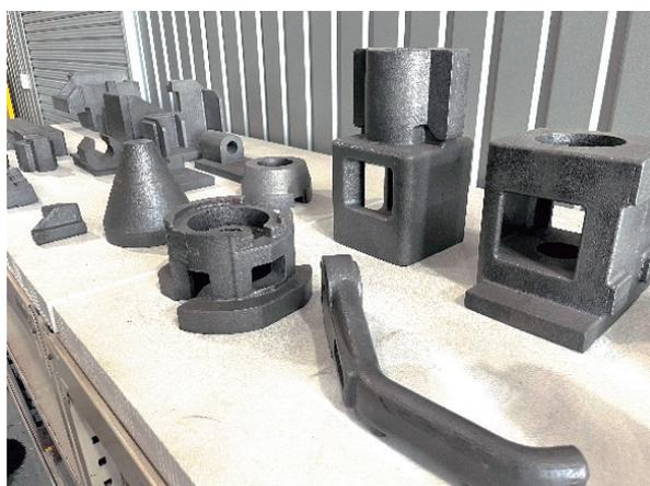
図4 砂加工により製造した鑄物
