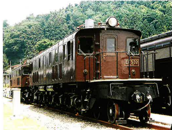
① EF53形電気機関車:EF532号 (2Co+Co2, Electric Locomotive)
