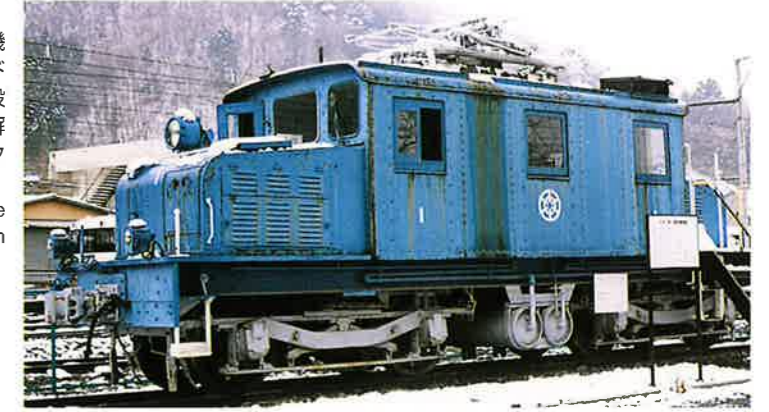
⑬ デキ1形電気機関車:デキ1号 (B 0 -B 0 Electric Locomotive)
