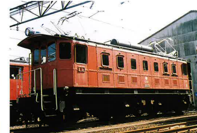
⑫ E51形電気機関車:E52号 (B 0 +B 0 Electric Locomotive)
