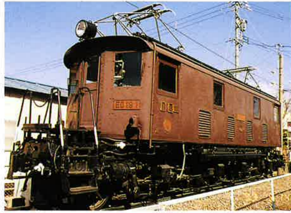
⑨ ED19形電気機関車:ED191号 (1B 0 +B 0 1 Electric Locomotive)
