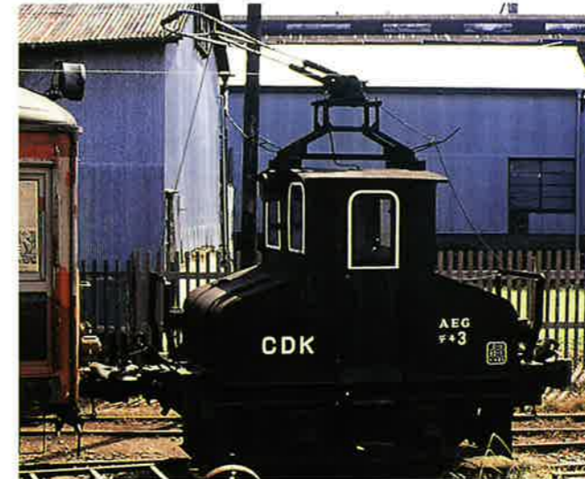
⑭ デキ3形電気機関車:デキ3号 (B 0 Electric Locomotive)
