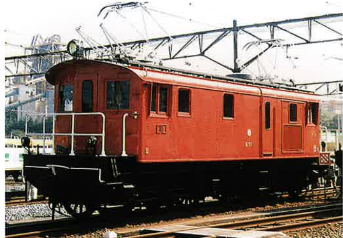
⑪ E71形電気機関車:E71号 (B 0 -B 0 Electric Locomotive)
