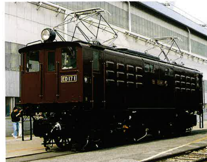
③ ED17形電気機関車:ED171号 (B0+B0 Electric Locomotive)
