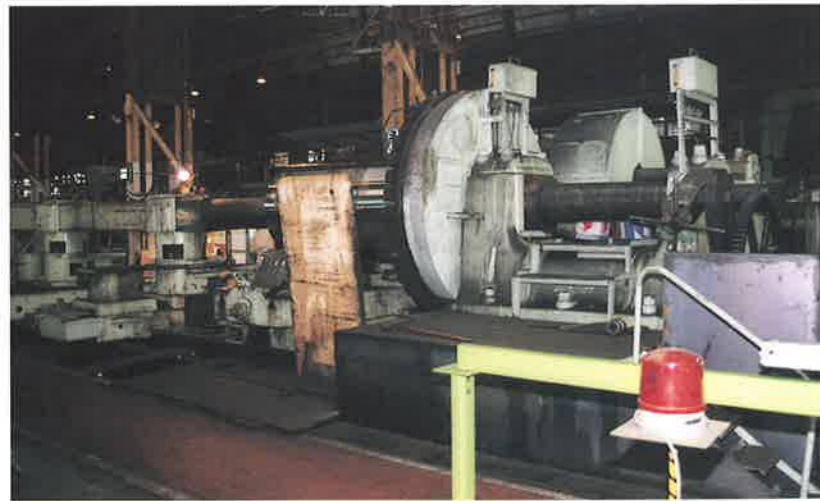
③旋盤 (Lathe) 大型工作機械 1908 (明治41) 年, Hulse & Co. Ltd., Manchester, 使用中 日本製鋼所の操業開始にあたりイギリスから輸入されたハルゼ (Hulse & Co. Ltd., Manchester) 製の大型旋盤で, 1908 (明治41) 年の製造。この旋盤の ベッド, サドル, 親ねじ, 主軸台などは原形を留め, 現在でも使用されている。
