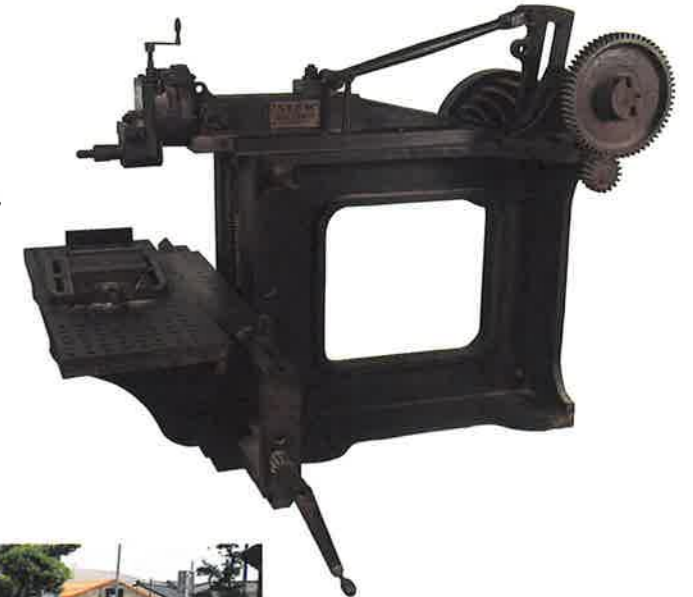
㊦形削り盤 (Shaping machine) 1863 (文久3) 年, Netherlandsche Stoom Boot Maatschappij (NSBM), 保存・展示
