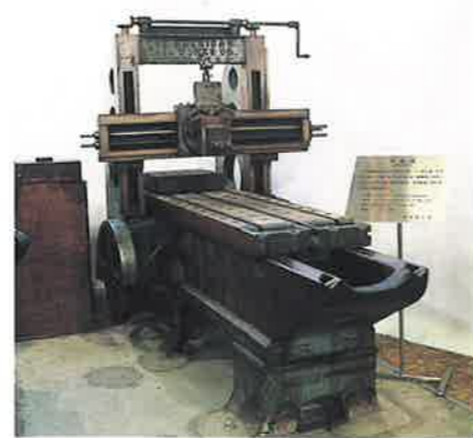
㊦平削り盤 (Planing machine) 1906 (明治39) 年, The American Tool Works Co. Cincinnati, 保存・展示
