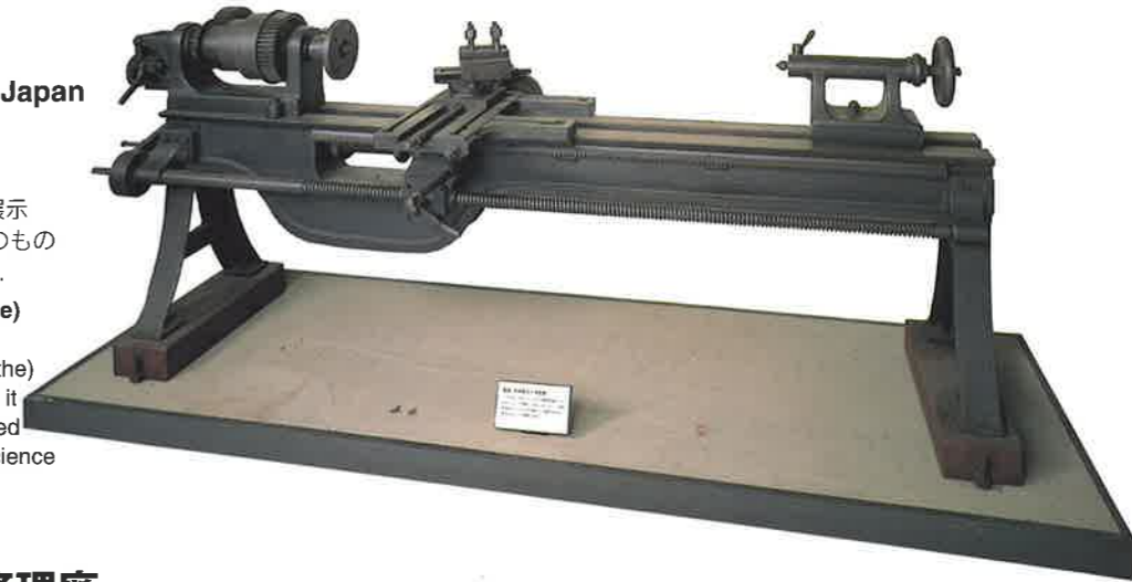
⑥車輪旋盤 (Car wheel lathe) 1905 (明治38) 年, Craven Brothers Ltd., Manchester, 保存・展示
