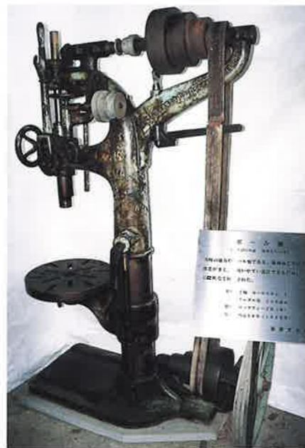
㊦ボール盤 (Drilling machine) 1906 (明治39) 年, W. F. & J. Barns Co. Rockford Ill., 保存・展示
