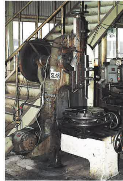
㊦立削り盤 (Slotting machine) 1890 (明治23) 年, E & Ph. Bouey Paris, 使用中
