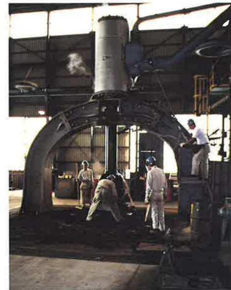
⑧スチームハンマ (Steam hammer) 容量 3t, 1865 (慶応1) 年, Internationale Crediet- en Handels-Vereeniging, Rotterdam, 使用中
