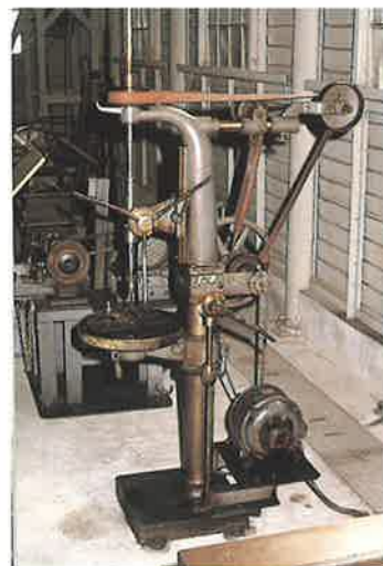
⑬ボール盤 (Drilling machine) 1885 (明治18) 年, 製造所不明, 保存・展示
