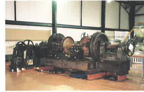
⑥車輪旋盤 (Car wheel lathe) 1905 (明治38) 年, Craven Brothers Ltd., Manchester, 保存・展示
