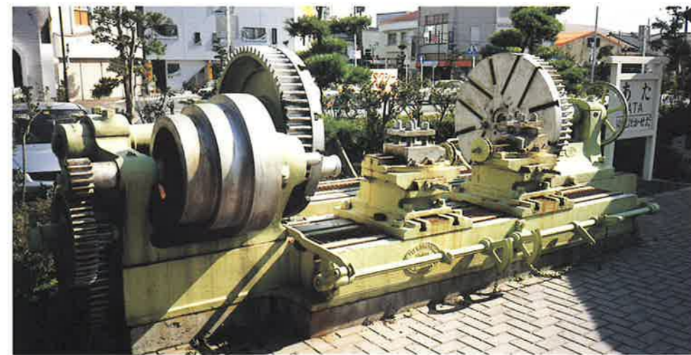
㊦車輪旋盤 (Car wheel lathe) 鉄道用大型旋盤, 1907 (明治40) 年, Craven Brothers Ltd., Manchester, 保存・展示 南薩鉄道 (鹿児島県) の機械工場で使用された車輪旋盤。イギリス・マンチェスターのクレイヴン・ブラザーズ (Craven Brothers Ltd, Manchester) で1907 (明治40) 年に製造。南薩鉄道記念館に保存・展示。
