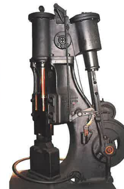
⑱エアハンマ (Pneumatic hammer) 1911 (明治44) 年, B. & Massey, Manchester, 使用中
