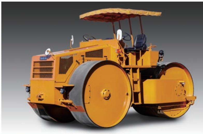
道路整備に不可欠な締固め機械(ロードローラ)のうち、3輪のマカダムローラは、1920年代までは欧米の機械が輸入されてきた。1930(昭和5)年に国産第1号の内燃機関搭載マカダムローラを製作販売開始した酒井工作所(現酒井重工業(株))は、1968(昭和43)年に革新的な新機種R1を開発した。
