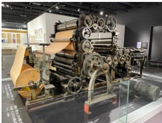
明治期に新聞社などでは、フランスのマリノニ社が開発した輪転機を印刷に使用していた。三田製作所(現(株)東京機械製作所)の石川角蔵は、このマリノニ社の輪転機をモデルに国内技術で小型化や新機能で日本の実情にあうように、1906(明治39)年に煽り式輪転機を開発し、石川式マリノニ型輪転機と呼ばれた。
