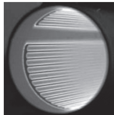
図2 円筒電極内部のプラズマの写真 (株式会社増田研究所提供)
