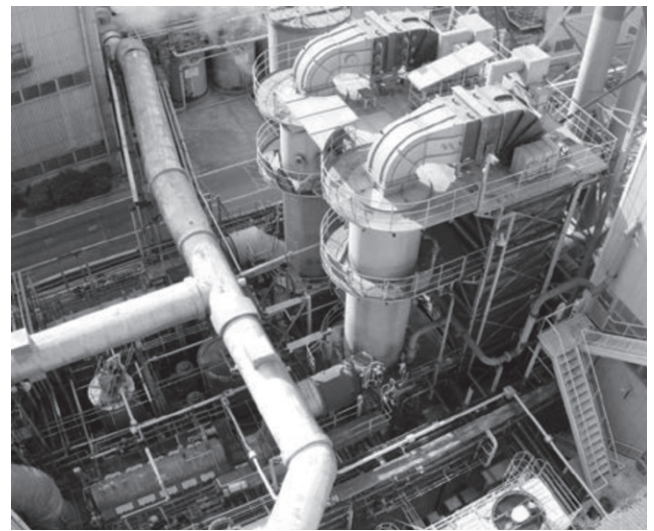
播磨工場1号炉 ガラス溶解量：215t/日 燃料：都市ガス 燃料量：1,100m 3 /h
