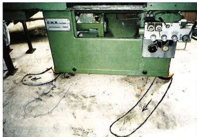
写真1 防振ゴムの上のマシニングが1.5m程北北東に移動した。
