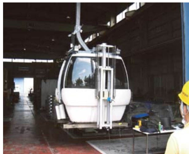
図5 コリオリ力で制振するゴンドラ (ばねで支えられた錘が受動的に上下する)
