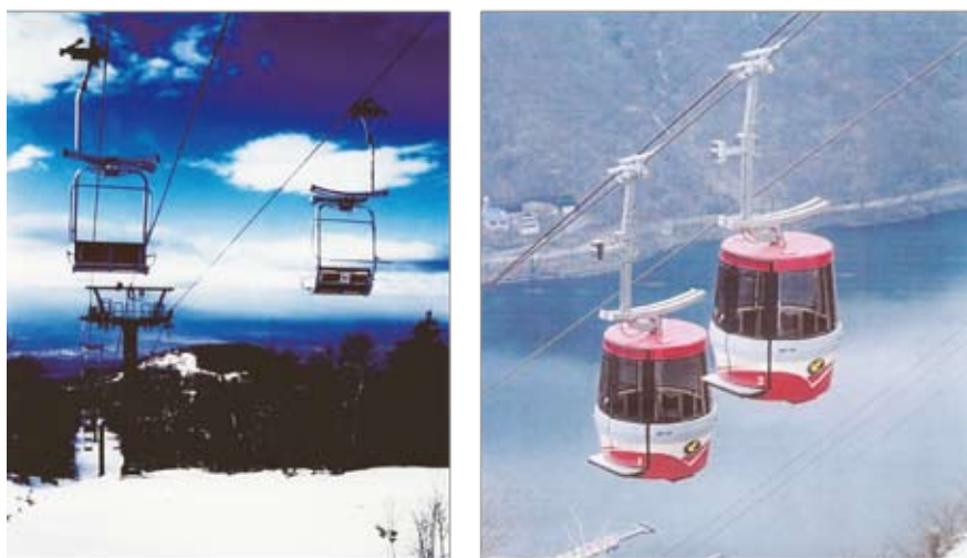
図3 左図：世界初の動吸振器の付いたリフト(1995年)、右図：同ゴンドラ(1996年)
