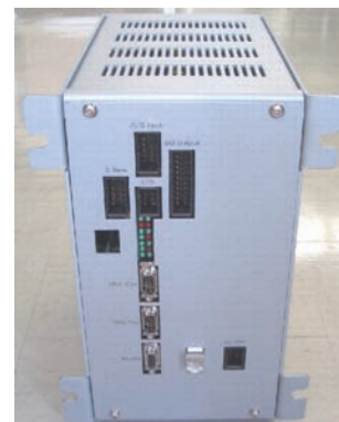
図8 開発した制御装置(試作品) (大きさ 200mm(W)×280mm(H)×260mm(D))
