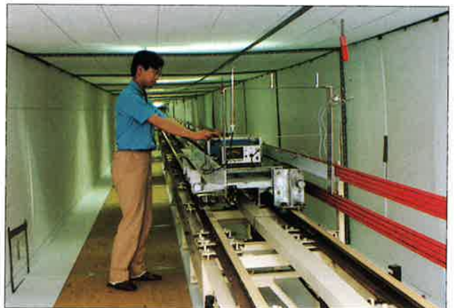
写真3 微風速計校正用走行台車
