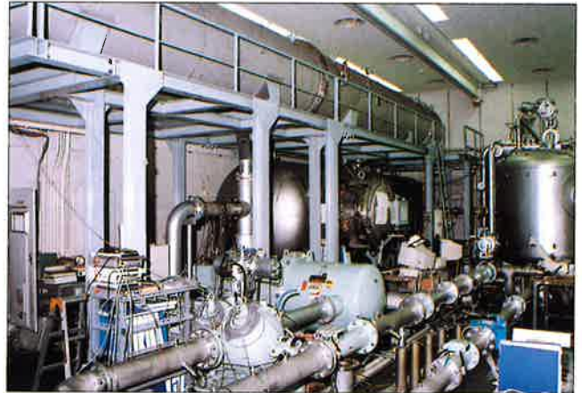
写真2 定積槽式高圧気体流量校正装置
