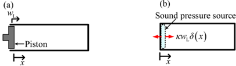
図2 変位加振を受ける一次元音場
