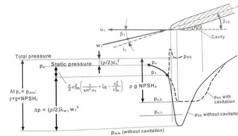
吸入圧力、液温、ポンプの回転速度、流量によって変化
