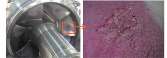
No.3冷却水ポンプにてキャビテーションと思われる異音が発生しており、分解点検の結果、インペラに最大深さ5mm程度のエロージョンが確認された。
