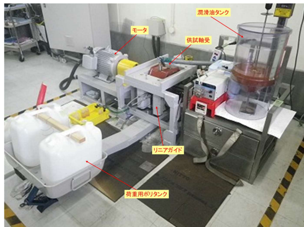
すべり軸受焼き付試験装置(異物混入)
