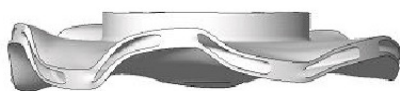
図 10-26 羽根車固有振動数解析結果 節直径数 \kappa = 5 のモード (6550 Hz)
