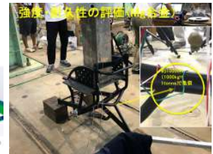
図3 大型材料試験機による破壊試験
