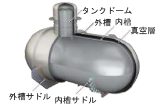
図2 蓄圧式液化水素輸送タンク
