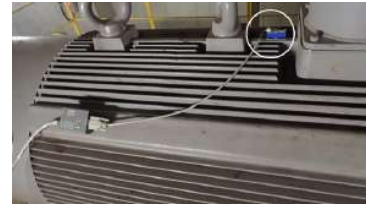
図3 電動機に取り付けられた振動センサ
