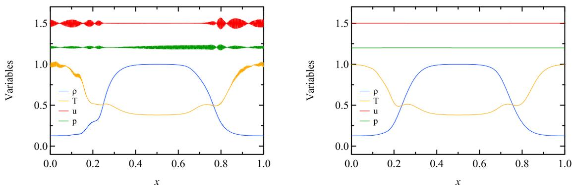
Fig. 5 超臨界圧 CH<sub>4</sub>/N<sub>2</sub> 接触面移流問題の結果（密度，温度，速度，圧力分布）．左が従来法，右が提案した APEC による結果．
